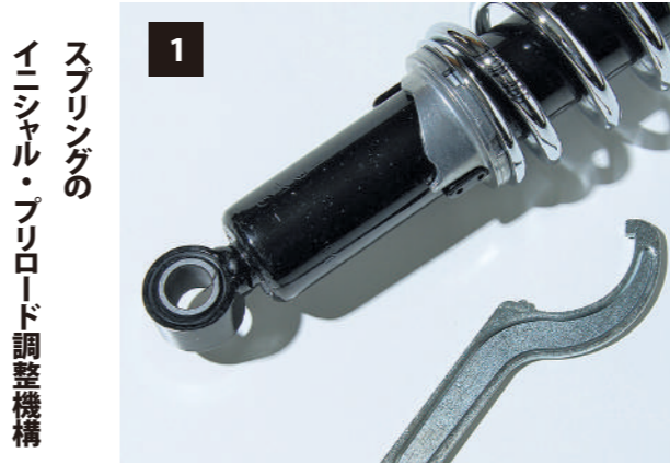
スプリングのイニシャル・プリロード調整機構
