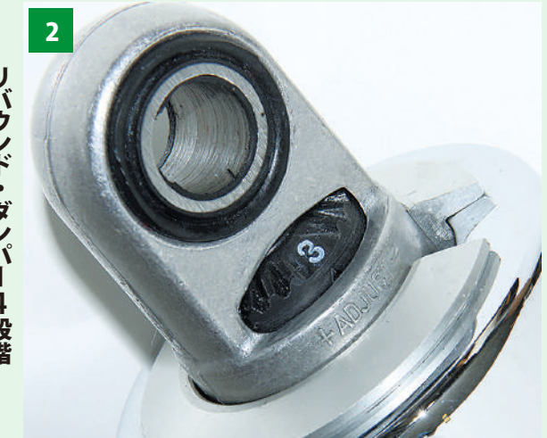
リバウンド・ダンパー(伸び側減衰力)調整機構
